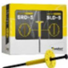
Najranije nakon 48h od lijepljenja možete početi s postavljanjem pričvrstica. Sidrite kroz ljepilo prema "W" shemi postavljanja pričvrstica. Minimalni broj pričvrstica po  $\text{m}^2$  je 6 kom, a točan broj mora biti proračunat od strane projektanta u odnosu na visinu objekta, zonu vjetrova itd. Detaljnija uputstva o proizvodu možete pronaći na QR code ili [www.testisthebest.com](http://www.testisthebest.com)
