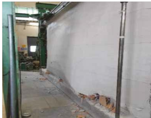
Završno ispitivanje ojačanog zida
