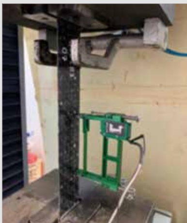
Direktno ispitivanje vlačne čvrstoće FRP laminata
