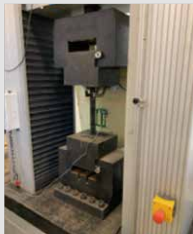
Uređaj za ispitivanje vlačne čvrstoće
