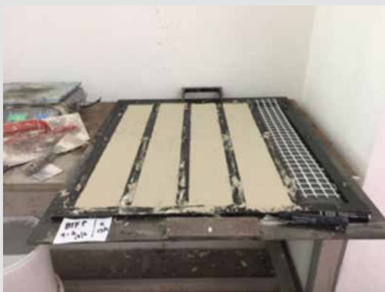
Izrada uzoraka za testiranje vlačne čvrstoće sustava
