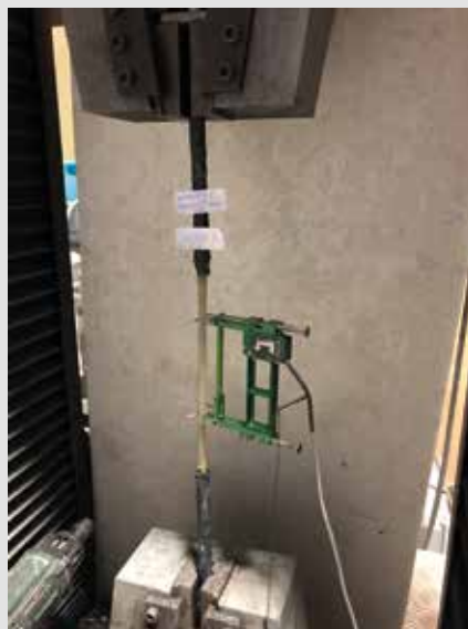
Direktno ispitivanje vlačne čvrstoće konektora
