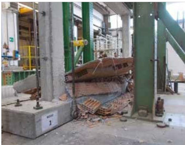
Ispitivanje završetka urušavanja nearmiranog zidanja
