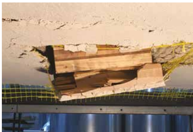
Ispitivanje sa str. mortom, mrežom i pričvrsnicama
