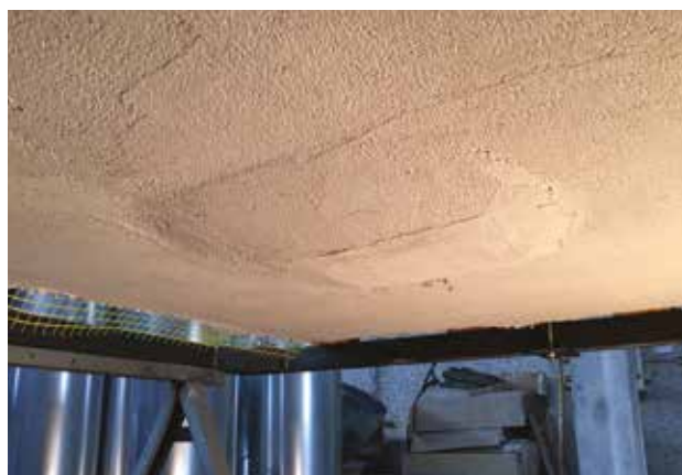
Ispitivanje sa str. mortom, mrežom i pričvrsnicama
