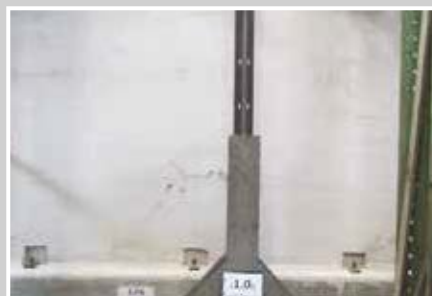
Ojačani uzorak, oštećenje pri pomaku od 1%
