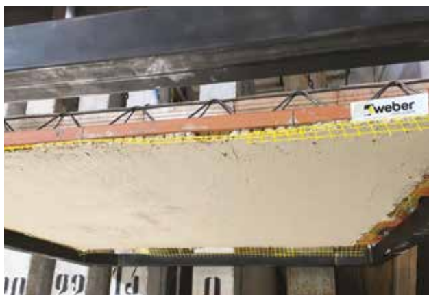
Ispitivanje sa str. mortom, mrežom i pričvrsnicama
