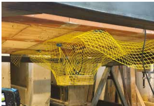
Ispitivanje sa mrežom i pričvrsnicama
