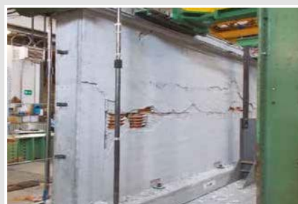
Neojačani uzorak, oštećenje od 1% pomaka
