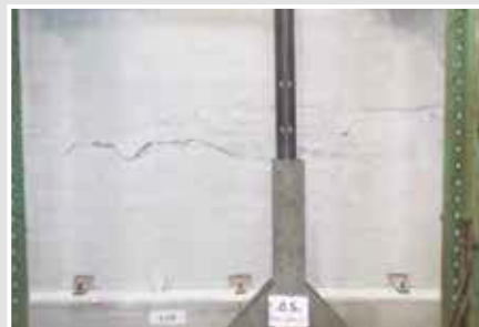
Neojačani uzorak, oštećenje pri pomaku od 0,5%
