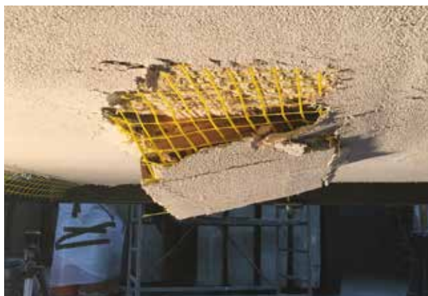
Ispitivanje sa str. mortom, mrežom i pričvrsnicama
