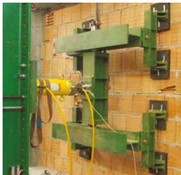
Detalji sustava aplikacije opterećenja
