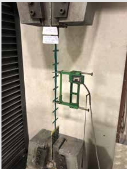
Direktno ispitivanje vlačne čvrstoće vlakana mreže
