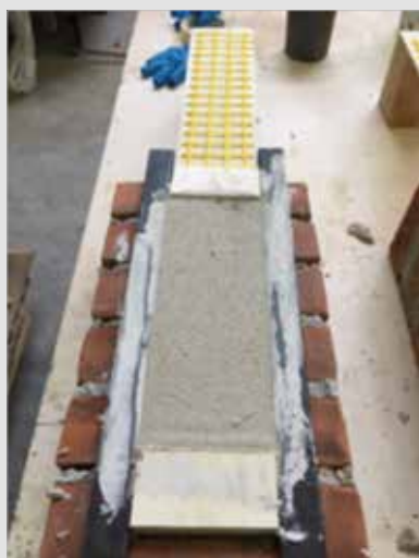
Priprema uzoraka za ispitivanja odvajanja od podloge
