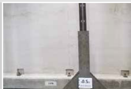
Ojačani uzorak, oštećenje od pomaka 0,5%
