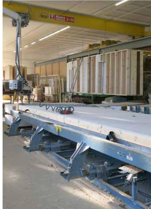
Nove ploče za uporabu na drvenoj konstrukciji Riduro proizvode se na lokaciji Bad Aussee. U osnovi se sastoje od impregnirane gipsane jezgre ojačane vlaknima i obloge od kartona visoke čvrstoće. Tako nastaje nova generacija gipsanih ploča koja pruža brojne prednosti:
